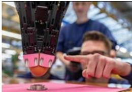
Bild 03: Smarter Roboter: BMW Azubis programmieren und steuern einen sensitiven Roboter für die Automobilproduktion so, dass dieser ein rohes Ei in einen Eierkarton legen kann.
